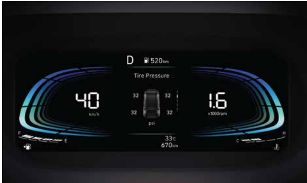
Cảm biến áp suất lốp có khả năng hiển thị giá trị áp suất của từng lốp
